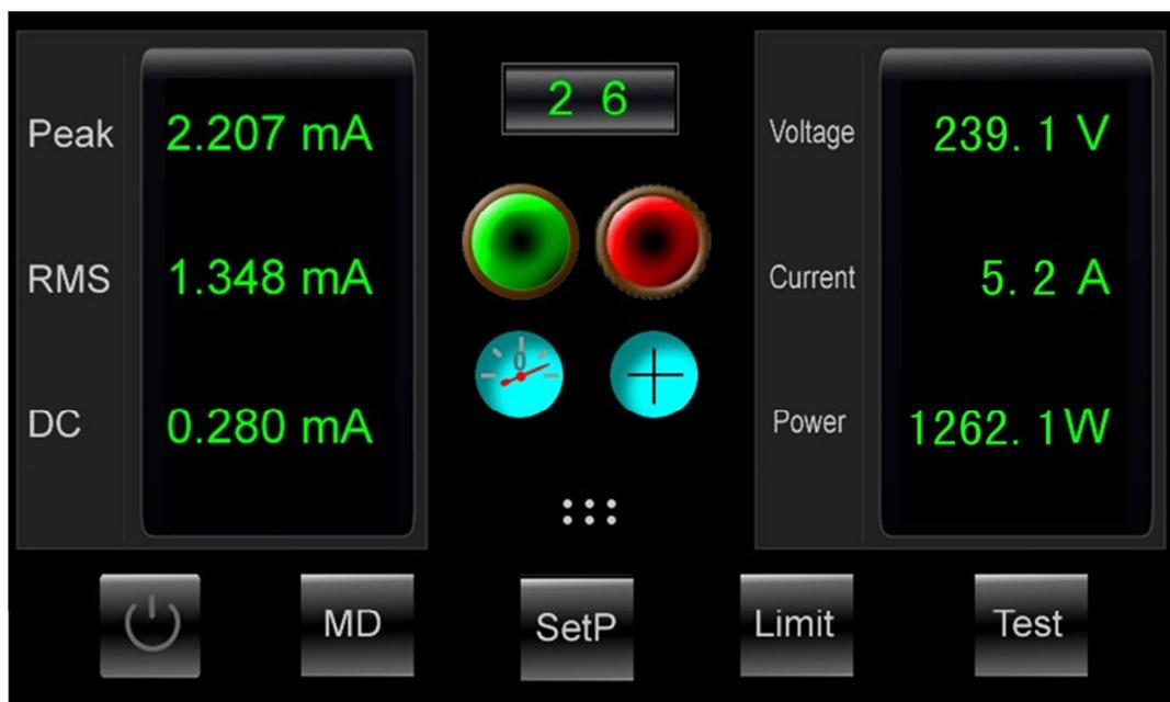
数据显示输出：DC 、Peak 、RMS 电压电流同时显示输出，时间显示，上限下限报警设置。
