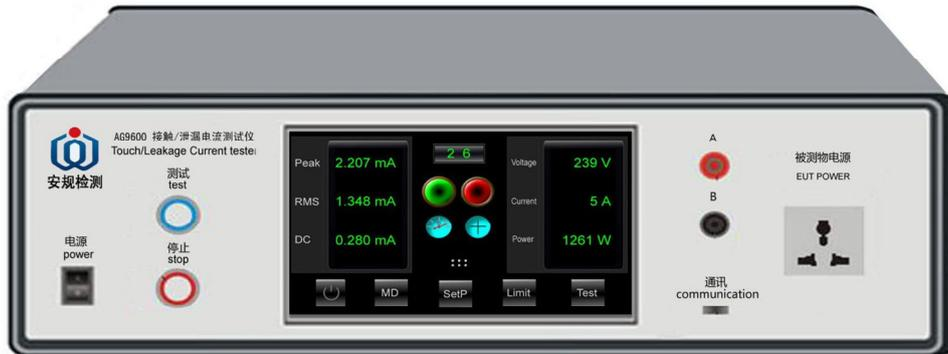
AG96000 系列接触电流测试仪是用来满足四种安规测试（耐压测试，绝缘电阻测试，接地电阻测试，泄漏电流测试）之一的安全测试需求。完全符合 GB/T12113-2003《接触电流和保护导体电流的测量方法》，测试领域包括一般电子、电气设备的安全要求。适用于家用电器 GB4706.1、通讯技术产品 GB4943、音视频产品 GB8898、灯具类 GB7000.1）、医疗器械 9706.1、测量控制和实验室用电气设备 GB4793.1 等类似电子设备的安全要求接触电流部分。
